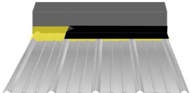
3. Con la mano o con la ayuda de un rodillo de silicona, comience a moldear/ajustar la cinta a la superficie ondulada. Asegúrese de no estirar demasiado la cinta en un solo punto (por ejemplo, las esquinas), para evitar cualquier riesgo de dañarla.
