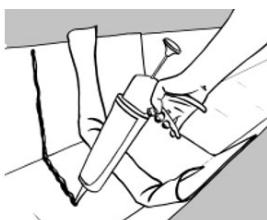
A superfície de colagem deve ter um mínimo de 40 mm. Dobre a membrana para trás e aplique 2 cordões de adesivo com 8 mm de diâmetro ao longo e em cada lado da junta e um cordão extra nos cantos da calha. O segundo cordão de adesivo deve ser aplicado a 10 mm da borda da membrana Effisus Ecofaçade.
