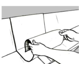
Instale a membrana Effisus Ecofaçade centrada com o Effisus 2Bond DS previamente aplicado. Remova o outro lado da película protetora da fita Effisus 2Bond DS ao começar a colar a membrana Effisus Ecofaçade. Deve-se ter um cuidado especial para garantir que a membrana siga os cantos da calha e que adira totalmente à fita Effisus 2Bond DS nos cantos. Aplique pressão com um rolo de silicone ou de aço em toda a parte superior da membrana.
