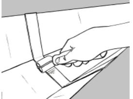
Pressione a fita com um rolo de silicone ou aço. Ter especial cuidado para garantir que a fita esteja completamente aderida e ajustada aos cantos da calha.
