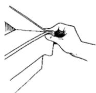
Durante a aplicação da Fita Effisus SealExpand no caixilho, é necessário dobrar a fita nos cantos, com uma largura igual ou superior à espessura mínima da fita utilizada. Esta poderá assim expandir corretamente no intervalo de junta para o qual foi dimensionada.
