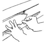
Em todos os remates, sobreposições e interrupções da Fita Effisus SealExpand deve ser realizado um corte da fita na diagonal nas duas extremidades a unir. Estas deverão ser sobrepostas e o corte deverá ser realizado em simultâneo nas duas extremidades, assegurando desta forma que estas fiquem perfeitamente justapostas e, consequentemente, a perfeita união da fita.
