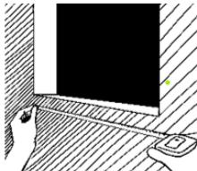
Medir as dimensões do vão e do intervalo de junta onde será aplicada a Fita Effisus SealExpand. Consultar a Effisus para confirmação das dimensões de fita indicadas para a aplicação.
