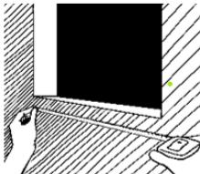
Mida las dimensiones del hueco y del espacio de junta donde se aplicará la cinta Effisus SealExpand.
