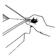
Durante la aplicación de la cinta Effisus SealExpand en el marco, es necesario doblar la cinta en las esquinas, con una anchura igual o superior al espesor mínimo de la cinta utilizada. De este modo, podrá expandirse correctamente en el intervalo de junta para el que ha sido dimensionada. La cinta Effisus SealExpand puede atravesarse con fijaciones, garantizando así su correcto sellado al agua.
