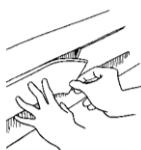
En todos los remates, superposiciones e interrupciones de la cinta Effisus SealExpand, se debe realizar un corte diagonal de la cinta en los dos extremos que se van a unir. Estos deben superponerse y el corte debe realizarse simultáneamente en los dos extremos, asegurando así que queden perfectamente yuxtapuestos y, por consiguiente, que la unión de la cinta sea perfecta.
