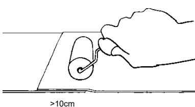
As juntas entre as membranas Effisus Easyrepair devem ter uma sobreposição mínima de 100 mm.
