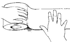
Para aplicar la cinta Effisus 2Bond DS, retire una de las capas protectoras y aplíquela sobre la superficie que desea proteger o pegar. Frote o presione con la mano o con un rodillo de acero para activar el proceso de pegado. Retire la segunda capa protectora y aplique la segunda superficie sobre la cinta, presionando.
