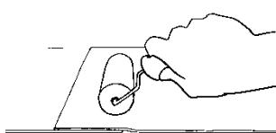
Las juntas entre las cintas Effisus 2Bond DS deben tener una superposición mínima de 100 mm. Pegue la cinta Effisus 2Bond DS superior sobre la cinta Effisus 2Bond DS inferior. Frote o pase un rodillo de acero con presión para activar el proceso de pegado.
