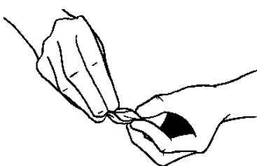
La cinta Effisus 2Bond DS también se puede utilizar como masilla selladora. Retire las capas protectoras y enróllela como si fuera un cordón. Coloque Effisus 2Bond DS sobre la abertura y moldee para sellarla. Se puede utilizar para sellar tornillos o clavos.
