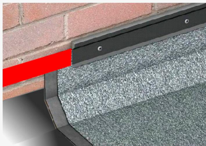
8 – Selagem de perfurações na fixação de barras de terminação
