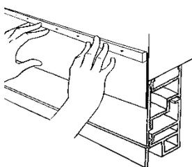
Caso a superfície de colagem realizada com o Adesivo Effisus Bonding KF seja inferior a 40mm é necessário fixar mecanicamente a Membrana Effisus Ecofacade P-Fix. A fixação mecânica é realizada com barras de terminação em alumínio fixadas com um espaçamento máximo de 250mm.
