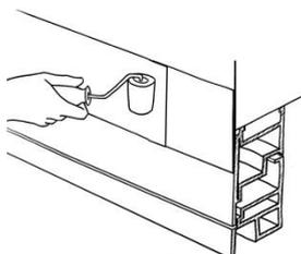
As juntas de sobreposição deverão ter um mínimo de 80mm. Cortar o perfil de encaixe da membrana onde necessário, de forma a permitir uma perfeita justaposição entre a membrana inferior e superior. Aplicar 2 cordões de Adesivo Effisus Bonding KF com diâmetro de 8 a 10mm sobre a Membrana Effisus Ecofacade P-Fix inferior. Sobrepor a Membrana Effisus Ecofacade P-Fix superior e pressionar firmemente com um rolo de aço (até que o adesivo se espalhe numa camada uniforme com aprox. 1mm de espessura).
