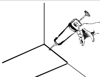
Deverá ser realizada a selagem perimetral das Membranas Effisus Ecofacade aplicadas e a selagem de todos os cantos, sobreposições e outros remates com o Selante Effisus Block JP.
