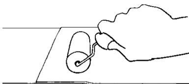
As juntas de sobreposição deverão ter um mínimo de 80mm. Aplicar o Adesivo Effisus Bonding KT sobre a membrana inferior e na face inferior da Membrana Effisus Ecofacade a sobrepor. Deixar secar. Sobrepor a Membrana Effisus Ecofacade e pressionar firmemente com um rolo de aço.
