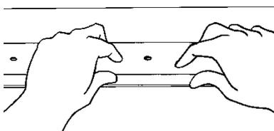
Caso a superfície de colagem seja inferior a 40mm é necessário fixar mecanicamente a Membrana Effisus Ecofacade. A fixação mecânica é realizada com barras de terminação em alumínio fixadas com um espaçamento máximo de 250mm.
