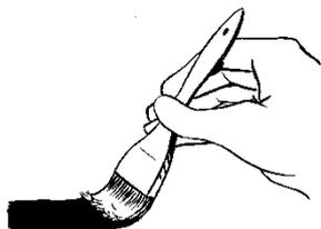
As superfícies de colagem deverão ter um mínimo de 40mm. Agitar devidamente o Adesivo Effisus Bonding KT. Aplicar o Adesivo Effisus Bonding KT com um rolo ou trincha na superfície de colagem e na Membrana Effisus Ecofacade. Deixar secar completamente e só depois aplicar a Membrana Effisus Ecofacade, sem tensão, sobre a superfície. Pressionar firmemente com um rolo de aço.
