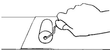
As juntas de sobreposição deverão ter um mínimo de 100mm. Aderir a Membrana Effisus Easyrepair superior sobre a Membrana Effisus Easyrepair inferior. Pressionar firmemente toda a junta de sobreposição com um rolo de aço.
