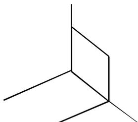
Nunca tensionar a Membrana Effisus Easyrepair na tentativa de que esta se ajuste ao canto. Deixar colar gentilmente, ajustando-se a membrana ao canto sem tensões. Para selagens perimetrais, de cantos e outros remates poderá ser utilizado o Selante Effisus Block EK.
