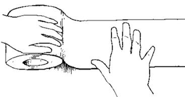
As superfícies de colagem deverão ter um mínimo de 2.5cm para cada lado da junta a selar. Aplicar a Membrana Effisus Easyrepair sobre a área a selar, removendo a película protectora gradualmente de forma a evitar a contaminação do adesivo antes da colagem. Aplicar gentilmente e sem introduzir tensões na membrana. Pressionar firmemente toda a superfície de colagem com um rolo de aço.
