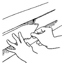
Em todos os remates, sobreposições e interrupções da Fita Effisus SealExpand deve ser realizado um corte da fita na diagonal nas duas extremidades a unir. Estas deverão ser sobrepostas e o corte deverá ser realizado em simultâneo nas duas extremidades, assegurando desta forma que estas fiquem perfeitamente justapostas e, conseqüentemente, a perfeita união da fita.
