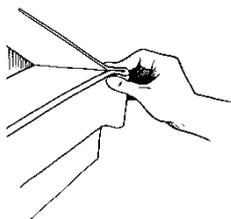
Durante a aplicação da Fita Effisus SealExpand no caixilho, é necessário dobrar a fita nos cantos, com uma largura igual ou superior à espessura mínima da fita utilizada. Esta poderá assim expandir correctamente no intervalo de junta para o qual foi dimensionada.
