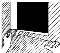
Medir as dimensões do vão e do intervalo de junta onde será aplicada a Fita Effisus SealExpand. Consultar a Up-Way Systems para confirmação das dimensões de fita indicadas para a aplicação. As superfícies deverão estar secas. Limpar e desengordurar todas as superfícies lisas com o Líquido de Limpeza Effisus Setup PR.
