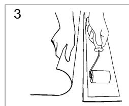
Posicionar a Fita Effisus Adjoin TP sobre a superfície onde foi aplicado o primário e colar progressivamente à medida que se vai retirando a película protectora inferior da fita.
