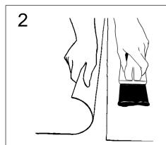
As superfícies da área da sobreposição que irão ficar em contacto com a Fita Effisus Adjoin TP devem ser completamente limpas e tratadas com o Primário Effisus Coat SP antes da aplicação da Fita Effisus Adjoin TP. Aplicar o Primário Effisus Coat SP em ambas as superfícies da membrana (inferior e superior) com a escova fornecida ou com um rolo, tendo o cuidado de espalhar devidamente o primário antes de este secar.
