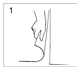
Posicionar as duas Membranas Effisus Ecoroof+ tal como deverão ficar após a selagem da junta (a membrana superior deverá sobrepor a inferior aprox. 10 cm). Deve ser feita uma marcação prévia na Membrana Effisus Ecoroof+ inferior com uma linha em todo o comprimento da junta marcando o ponto onde a Membrana Effisus Ecoroof+ superior termina + 1 cm (limite onde deverá terminar a aplicação da Fita Effisus Adjoin TP).
