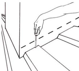
Commencer l'application de la membrane Effisus Cobra sur le côté inférieur de la conduite, selon l'inclinaison de la couverture.
