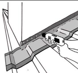
Appuyer la membrane sur la conduite, suivant la ligne directrice marquée au point 2.
