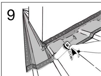
Pour achever l'installation appliquer un cordon de mastic Effisus Bonding KFP autour du périmètre supérieur et inférieur des membranes appliquées et sur tous les joints visibles.
