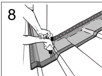
Ancrer les chevauchements entre les membranes, dans les zones où les membranes supérieures ont les extrémités avec de l'aluminium intégré, avec un espacement maximal de ancrages d'environ 35 mm.
