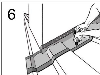
Commencer l'ancrage de la membrane à la couverture avec 1 ancrage aligné avec chacune des extrémités du côté de la conduite.
