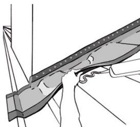
Soulever la surface de la membrane de la couverture et appliquer un cordon continu de mastic Effisus collage KF + P sur la couverture (ce cordon de mastic doit coïncider avec la ligne où la membrane sera ancrée sur la couverture).
