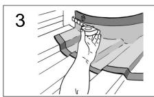
Commencer la fixation de la membrane à la conduite, en fixant la première vis à une distance de 50 mm de l'extrémité de la membrane. Continuer la fixation avec 8 vis de fixation avec un espacement d'environ 35 mm entre elles, en ajustant la membrane à la forme de la conduite.
