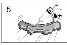
Terminer l'installation en appliquant du scellant Effisus Bonding KF+P aux extrémités de la membrane, et sur tout autre joint visible.
