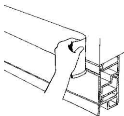
Aplicar a Membrana Effisus Ecofacade P-Fix SA-Edge encaixando o perfil EPDM incorporado na membrana na ranhura compatível do perfil de caixilharia e/ou fachada.
