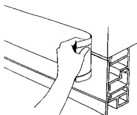
Colar progressivamente ao substrato a extremidade da Membrana Effisus Ecofacade P-Fix SA-Edge com banda auto-adesiva incorporada à medida que se retira a película protectora. Pressionar firmemente com um rolo de aço a superfície de colagem.
