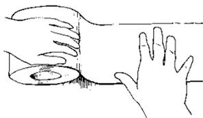
As superfícies de colagem deverão ter um mínimo de 5cm para cada lado da junta a selar. Aplicar a Fita Effisus Bond SF sobre a área a selar, removendo a película protectora gradualmente de forma a evitar a contaminação do adesivo antes da colagem. Aplicar gentilmente e sem introduzir tensões na membrana. Pressionar firmemente toda a superfície de colagem com um rolo de aço.
