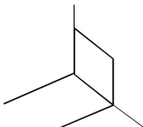
Nunca tensionar a Fita Effisus Bond SF na tentativa de que esta se ajuste ao canto. Deixar colar gentilmente, ajustando-se a membrana ao canto sem tensões. Para selagens perimetrais, de cantos e outros remates poderá ser utilizado o Selante Effisus Block EK.
