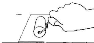
As juntas de sobreposição deverão ter um mínimo de 100mm. Aderir a Fita Effisus Bond SF superior sobre a Fita Effisus Bond SF inferior. Pressionar firmemente toda a junta de sobreposição com um rolo de aço.
