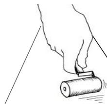
Após a secagem do primário, aplicar de imediato a Fita Effisus Bond FT, retirando gradualmente a película protectora da fita e colando. Pressionar e moldar a fita com a mão na forma e posição pretendidas. Pressionar firmemente com um rolo de silicone (com 5.08cm de largura).
