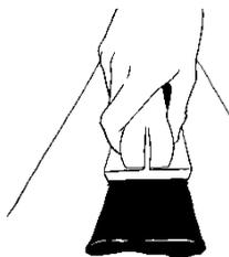
Aplicar o Primário Effisus Coat SP em todas as superfícies sobre as quais irá colar a Fita Effisus Bond FT, com a escova fornecida, tendo o cuidado de espalhar devidamente o primário antes de este secar. Deixar que o primário seque completamente (ao toque não deverá haver transferência de material). A secagem demora em média 20 minutos. Nota: Para temperaturas inferiores a 5°C ter especial cuidado de forma a eliminar a possibilidade de ocorrência de condensações à superfície do primário.
