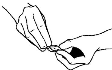
A Fita Effisus 2Bond DS também pode ser utilizada como uma massa, para isso remover ambas as películas protectoras e enrolar em forma de massa ou cordão. Aplicar sobre a junta e moldar de forma a selar a junta. A Fita Effisus 2Bond DS pode ser utilizada para selagem de perfurações com parafusos ou pregos, não irá contrair com o tempo ou afastar-se do parafuso.
