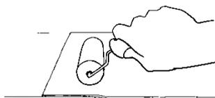
As juntas de sobreposição deverão ter um mínimo de 100mm. Aderir a Fita Effisus 2Bond DS superior sobre a Fita Effisus 2Bond DS inferior. Pressionar firmemente toda a junta de sobreposição com um rolo de aço.
