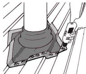
Deslizar novamente o Effisus Stopper MR até à posição pretendida. Iniciar a fixação do Effisus Stopper MR à cobertura com uma fixação em 2 extremidades opostas do Effisus Stopper MR. Completar a fixação do Effisus Stopper MR à cobertura garantindo que o espaçamento entre fixações é inferior a 40mm e um acompanhamento perfeito da configuração da cobertura.
