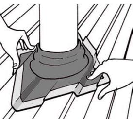
Posicione o Effisus Stopper MR de forma a que este forme um losango em relação ao canelado da cobertura (como na imagem).
