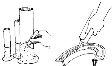
Aplicar o selante estrutural/adesivo Effisus Stopper M-1 na base do tubo/perfil de atravessamento e desde da base em toda a superfície até 7,5cm acima da cobertura. Alisar com uma espátula a superfície do selante aplicado. Segurar uma das duas secções do molde exterior e aplicar o Selante Effisus Stopper M-1 em cordões contínuos sobre toda a superfície do molde e também na zona de ligação à segunda secção. Aplicar o selante na secção seguinte do molde de igual forma.
