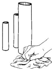
Remover todos os resíduos de silicones, mastiques, cimento ou asfalto que tenham sido previamente aplicados da área a selar (incluindo do tubo/perfil de atravessamento (s)).
