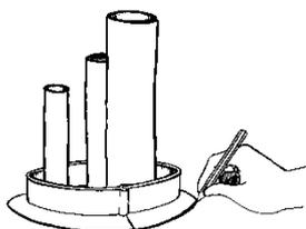
Posicionar os moldes exteriores Effisus Stopper EC/CE na posição pretendida. Utilizar um marcador e marcar na superfície da cobertura o perímetro exterior do molde. Remover o molde.
