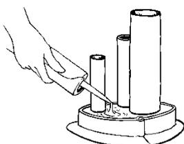
Preencher a totalidade do interior do Molde Effisus Stopper EC/CE com o selante de preenchimento Selante Effisus Stopper 1-P até ao topo do mesmo. Alisar a superfície com uma espátula.
