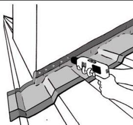
Encostar a membrana à conduta, seguindo a linha de orientação marcada no ponto 2.
