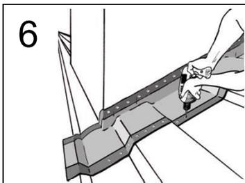
6 Iniciar a fixação da membrana à cobertura com 1 fixação alinhada com cada uma das extremidades do lado da conduta.
