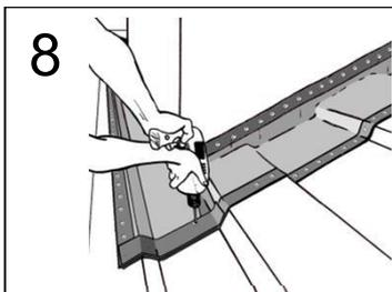
8 Fixar as sobreposições entre membranas, nas zonas em que as membranas superiores têm as extremidades com alumínio embutido, com um espaçamento máximo entre fixações de aprox. 35mm.
