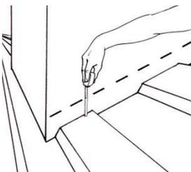
Iniciar a aplicação da membrana Effisus Cobra pelo lado mais baixo da conduta, de acordo com a inclinação da cobertura.
