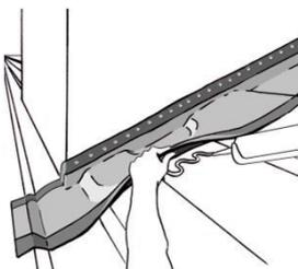
Levantar a membrana da superfície da cobertura e aplicar um cordão contínuo de Selante Effisus Block JP sobre a cobertura (este cordão de selante deverá coincidir com a linha onde a membrana irá fixar sobre a cobertura).
