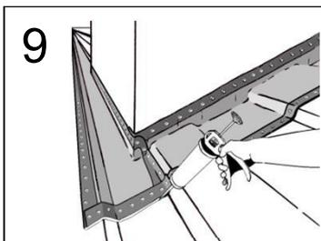
9 Para finalizar a instalação aplicar um cordão de Selante Effisus Block JP em todo o perímetro superior e inferior das membranas aplicadas e em qualquer junta visível.
